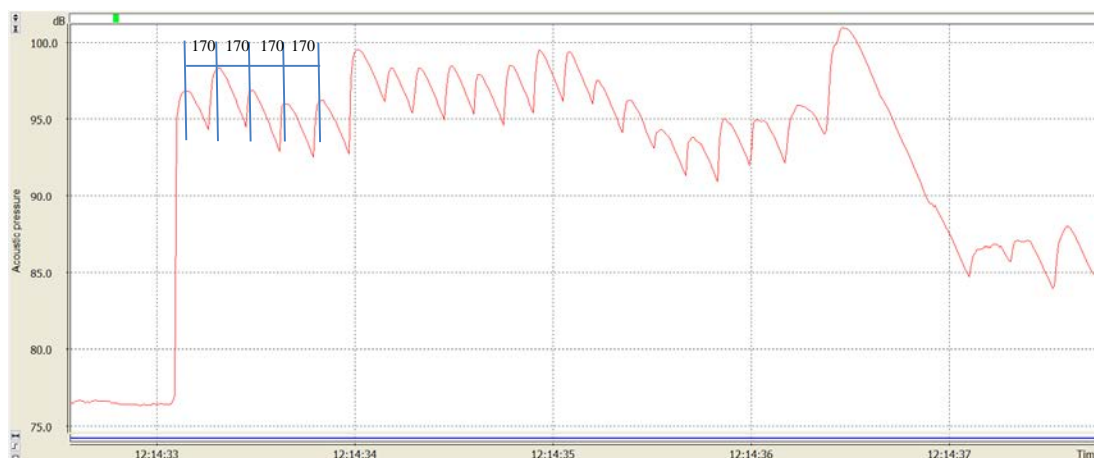
Diagram 2: Ljudnivå från skutknackning på 8 meters avstånd, (dBA, Fast, 10ms)
