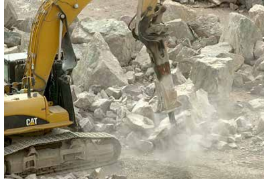
Maskinen som knackar skuten måste vara förstärkt för att skydda föraren om det skulle råka finnas kvarvarande odetonerat sprängmedel.
