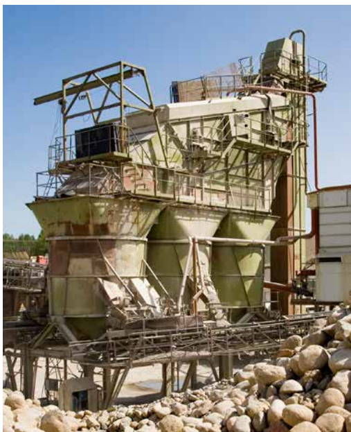
Gyratorisk kross fungerar ungefär som en mortel. Dessa krossar delas upp i spindelkrossar (för- och mellankrossning) samt konkrossar (mellan- efter- eller kubiseringskrossning).
