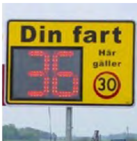
Figur 23: Exempel på hastighetsdisplay som ger feedback om fordonets hastighet.
