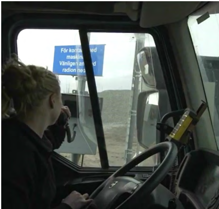
Figur 17: Exempel stolpe med komradio. Källa: Skanska.
