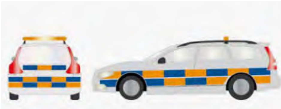
Figur 3: Battenburgmönster utvecklades för vägförvaltare (Trafikverket). Markeringen ger god effekt både i dagsljus och i mörker.
