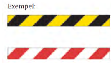
Figur 7: Exempel hindermärkning gul/svart eller röd/vit randiga fält. Källa: AFS 2008:13
