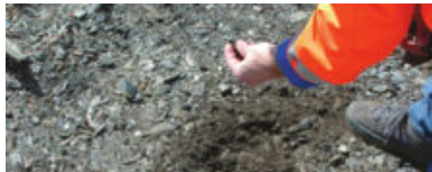
Figur 9. Exempel på a) nedkrossning från packning och b) skiffrigt, glimmerrikt bergmaterial som har krossats ned av byggtrafik och packning.
