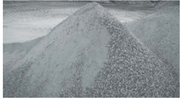
Figur 1. Exempel på materialseparation i upplag.
