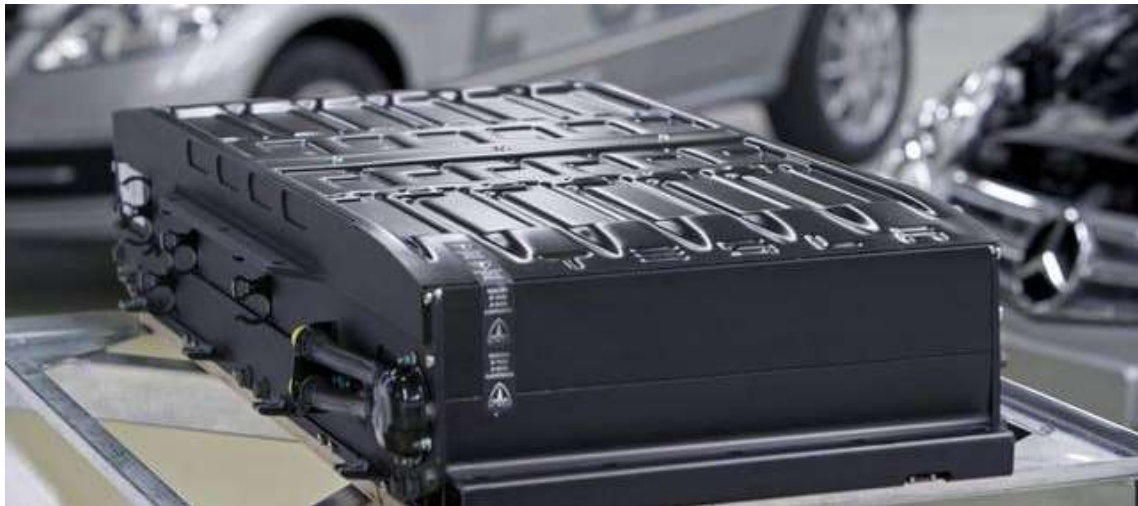
Figur 1 Batterier omfattar en mängd komponenter och förutom celler behövs kapsling, övervakning m.m. för att bilda batteripaket
