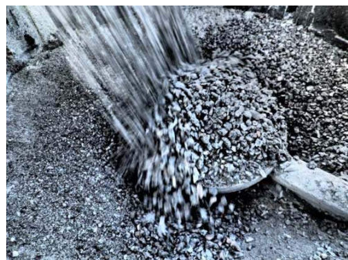
Figur 7. Materialflöde in i VSI-krossen
