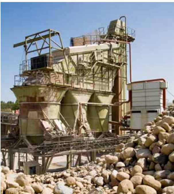
Gyratorisk kross fungerar ungefär som en mortel. Dessa krossar delas upp i spindelkrossar (för- och mellankrossning) samt konkrossar (mellan- efter- eller kubiseringskrossning).
