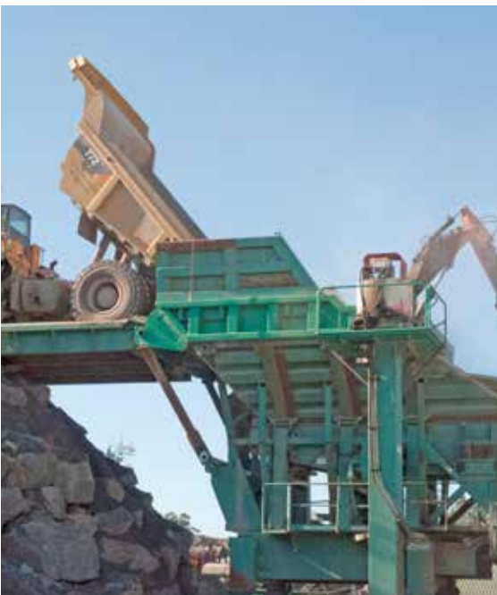
Käftkrossen delas upp i rotationskross (enbrickskross) och pendelkross. Käftkrossen är ofta det första steget i krossningsprocessen.
