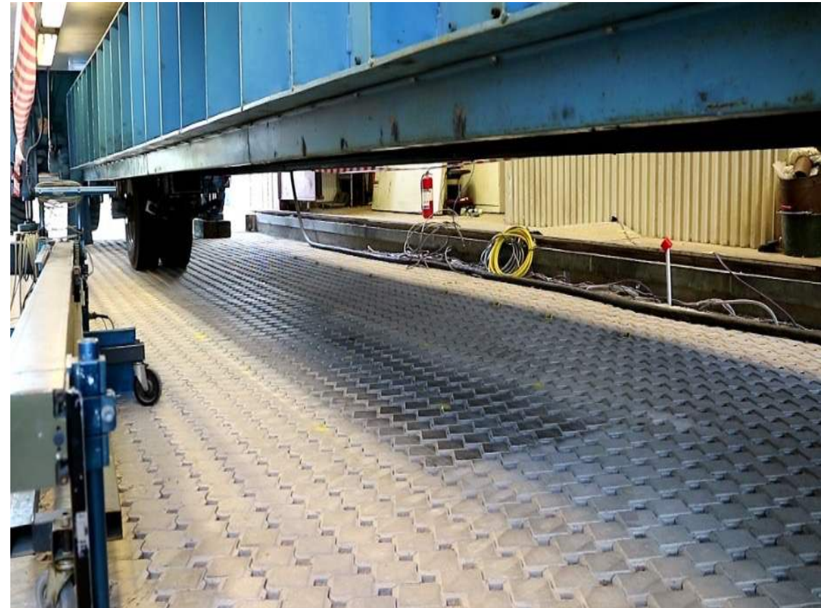
Provning av en livslängds belastning på 6 vecko
